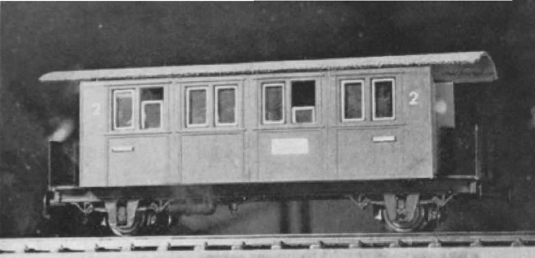
H0m + H0e Abb. 18 u. 19. Diese württembergischen Schmalspurwaggons – links ein Personenwagen, unten ein dreiachsiger Güterwagen – wird es für 12 mm- bzw. 9 mm-Schmalspurgleise geben (s. Abb. 21 u. 22).
