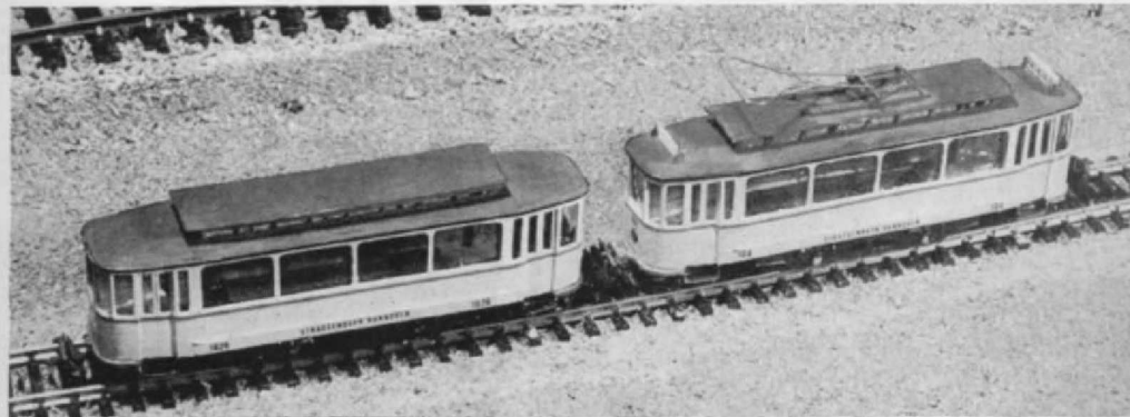
HO Abb. 17. Der Strab-Zug, Typ „Hannover 1907“; im Gegensatz zu Abb. 15 ist hier der Triebwagen mit einem Lyra-Bügel ausgerüstet, der noch ein Schleifstück erhalten wird.
