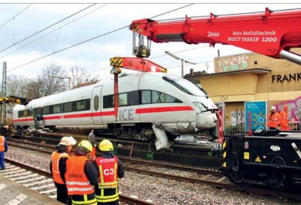
Erst am späten Nachmittag des 17. Februar konnte der verunfallte Triebkopf mit Hilfe der beiden Kranhilfszüge aus Fulda in einer aufwendigen Bergungsaktion eingeleistet werden.
