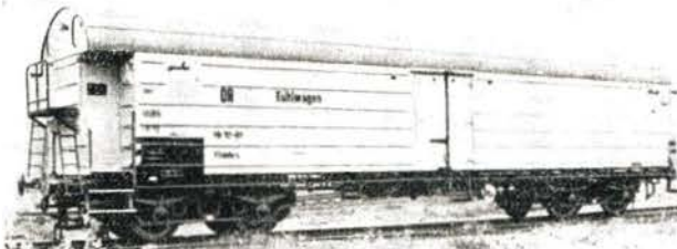
Bild 9 Kühlwagen mit Handbremse aus einer Sektion des Kühlzuges der Deutschen Reichsbahn
