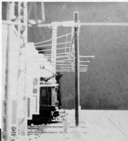
Abb. 9. Das Quertragwerk mit den daran befestigten Fahrleitungen samt Fahrdraht-Verlängerungen von der Seite gesehen. Die Schiebebühne wurde deutlichshalber herausgenommen.
