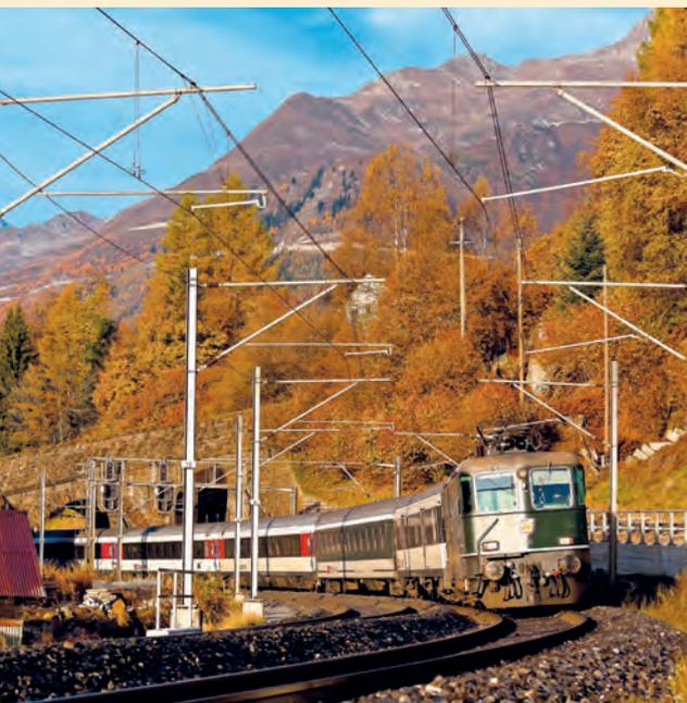
Mitte: Nur die SBB Re 4/4 11161 trägt noch das grüne Farbleid. Alle Schwestermaschinen sind längst errötet. Aber auch diese Maschine erhielt Rechtecklampen, UIC-Steckdose und Rangiergriffe. Die Aufnahme entstand beim herbstlichen Airolo an der Gotthardbahn.
