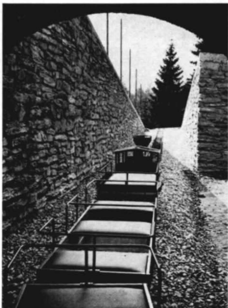
Abb. 3 u. 4. In Wambach (zwischen Wiesbaden und Bad Schwalbach) verkehrt im kürzlich eröffneten „Taunus-Wunderland“ eine von der Firma Schwingel gebaute Miniaturbahn mit 300 mm Spurweite. Die beiden Züge können je etwa 30 Personen befördern und an ihrer Spitze fahren Loks im amerikanischen Old-Timer-Stil. Die eigentlichen „Lokomotiven“ sind jedoch die Tender, in denen als Antriebsquelle je ein 5-kW-Motor untergebracht ist. Die 200 m lange Strecke ist mit Lichtsignalen und – für eine solche Miniaturbahn recht bemerkenswert – mit induktiver Zugsicherung ausgerüstet (1) und verläuft zur Freude der Fahrgäste sogar durch einige Tunnels.
