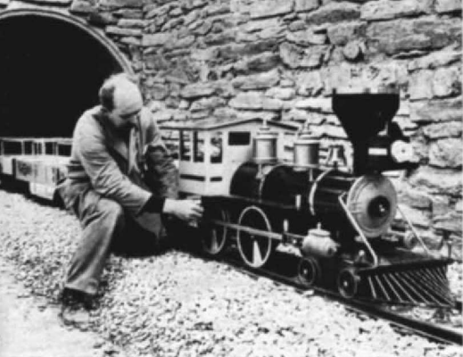
Abb. 3 u. 4. In Wambach (zwischen Wiesbaden und Bad Schwalbach) verkehrt im kürzlich eröffneten „Taunus-Wunderland“ eine von der Firma Schwingel gebaute Miniaturbahn mit 300 mm Spurweite. Die beiden Züge können je etwa 30 Personen befördern und an ihrer Spitze fahren Loks im amerikanischen Old-Timer-Stil. Die eigentlichen „Lokomotiven“ sind jedoch die Tender, in denen als Antriebsquelle je ein 5-kW-Motor untergebracht ist. Die 200 m lange Strecke ist mit Lichtsignalen und – für eine solche Miniaturbahn recht bemerkenswert – mit induktiver Zugsicherung ausgerüstet (1) und verläuft zur Freude der Fahrgäste sogar durch einige Tunnels.
