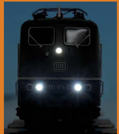
Die Stirnbeleuchtung kann unabhängig von den Schlusslichtern aktiviert werden. Für Rangiereinsätze ist es möglich, das Dreilicht-Spitzenlicht an beiden Fahrzeugenden zu aktivieren.
