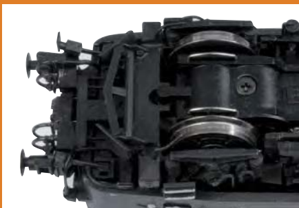
Die äußere Achse jedes Drehgestells ist mit zwei Drahtbügeln versehen. Sie dienen der Erkennung von Weichen bei deren Überfahrt, der Decoder spielt dann einen dazu passenden Sound ab.
