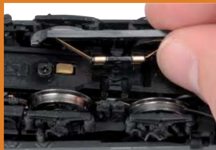
Die 151 kann sowohl im Zwei- als auch im Mittelleiter-Betrieb verwendet werden. Zum Umschalten wird lediglich der Schleifer eingesteckt, bzw. mit dem mitgelieferten Werkzeug entfernt.
