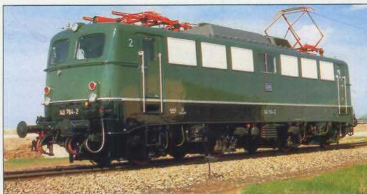
Bild 9: Bei den letzten Bauserien entfiel die umlaufende Regenrinne; die eckigen Lüftergitter waren nun aufgesetzt. So präsentierte sich die 140 764 kurz nach ihrer Ablieferung an die DB den Fotografen. Foto: Archiv BZA München
