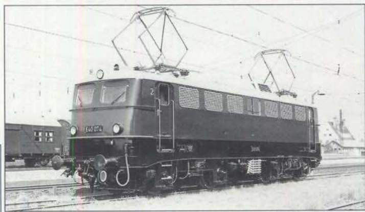
Bild 8: Die Loks der ersten Lieferserien verfügten noch über Einfachlampen und Lüftergitter mit waagrecht angeordneten Lamellen: E 40 074 am 24. April 1957 in München-Allach. Foto: Dr. Scheingraber
