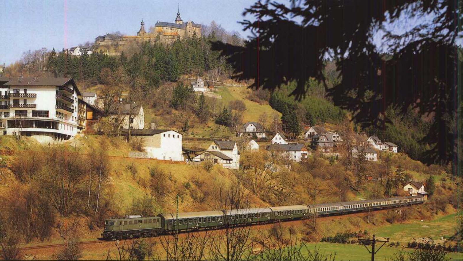
Bild 16: Auf der Frankenwaldbahn können die Lokomotiven der Baureihe 140 Schnellzüge mit acht Wagen ohne Unterstützung einer Schublok die Südrampe hinaufziehen, wie dieses Foto des D 403 (Leipzig – Nürnberg) vom 3. April 1981 bei Lauenstein belegt. Vor dem Einsatz der Baureihe 140 (und den sechssachsigen Güterzugloks der Baureihe 151) im Schnellzugverkehr auf der Frankenwaldbahn mußten die Schnellzüge auf der Nord- bzw. der Südrampe von Lokomotiven der Baureihe 194 nachgeschoben werden. Foto: Th. Wunschel
