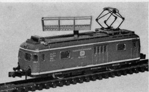
Abb. 15. Turmtriebwagen VT 93 mit beweglicher Arbeitsbühne und Scherenstromabnehmer.
