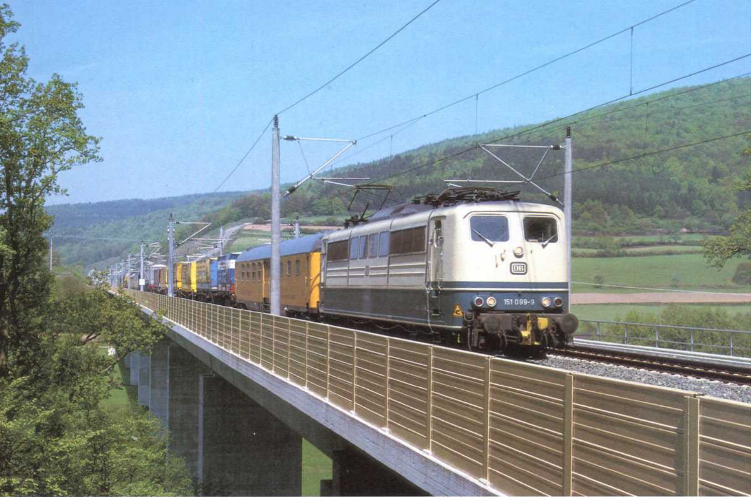
Bild 12: Um die Auswirkungen bei Begegnungen schnell fahrender ICE (sie verkehren voraussichtlich ab 1991) mit Güterzügen zu untersuchen, fanden auf der NBS Meßfahrten statt. Am 09.05.1987 überquert die 151 099 mit einem "Testgüterzug" die Sinnthalbrücke. Foto: K. Trabold
