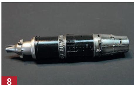
Auf die Grundierung wurde schwarzer Glanzlack von Tamiya aufgetragen. Direkt auf diesen Acrylgrund sprühte ich ALC 118 Gold Titanium in der alten Ausführung. Die Rezeptur hat sich allerdings mittlerweile geändert.
