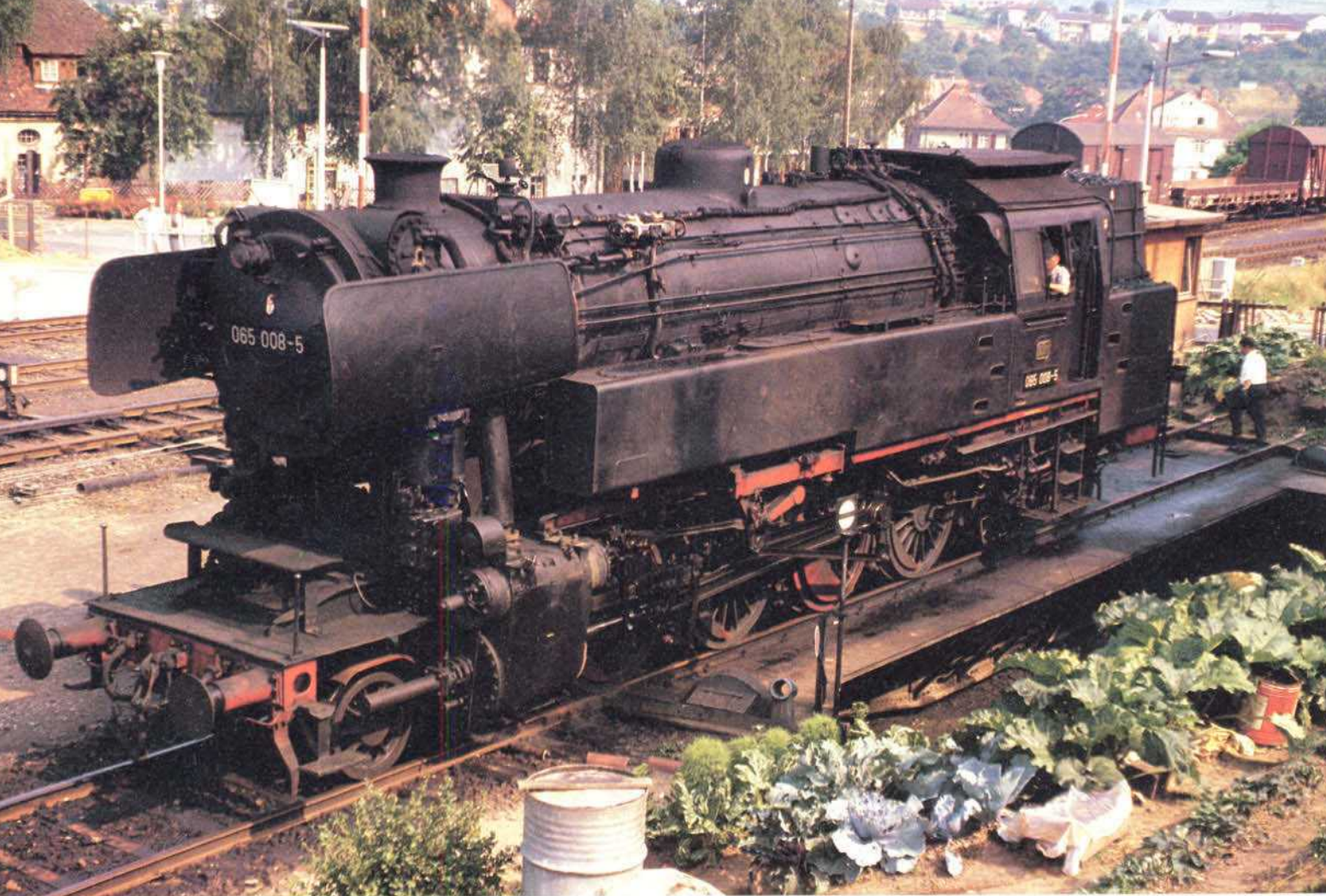
Bild 15: Die 065 008 ist mit dem P 3522 in Erbach/Odenwald eingetroffen und wird nun auf der dortigen Drehscheibe gedreht. Die Drehscheibe wurde übrigens mit der Druckluftpumpe der Lokomotive angetrieben (Sommer 1969). Foto: G. Goerke
