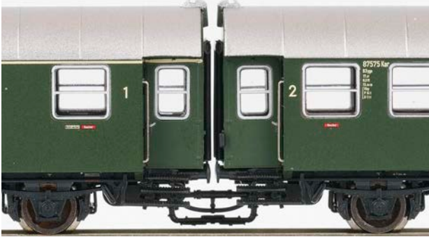
Piko: Die Wagen sind recht eng mit einem Steg gekuppelt, der auch die Andeutung von Brems- und Heizkupplung hat
