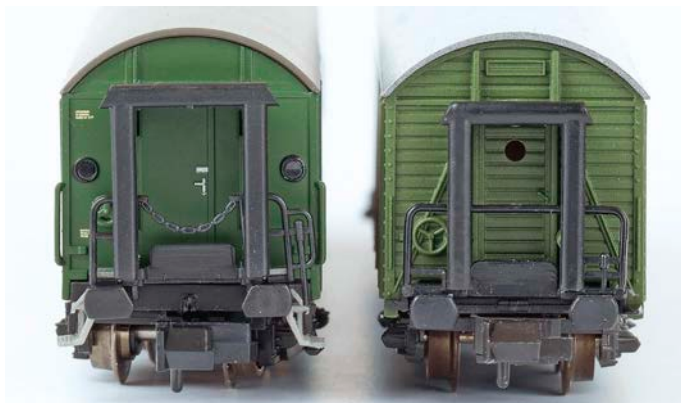
Minitrix: Die unterschiedlich gestalteten Stirnseiten-Übergänge der MDyge 986 von Minitrix und Roco (rechts)
