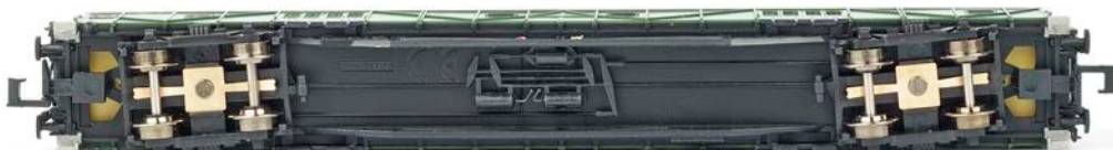
Minitrix: Die Bremsanlage ist angesteckt. Der Strom wird von den Achsen abgenommen
