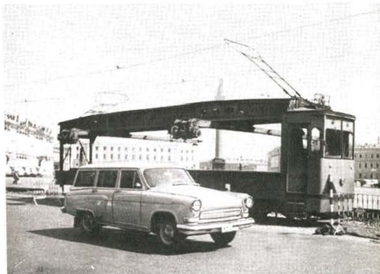
Bild 7 Leningrad — Begegnung zweier Triebwagen in der Kuibyschew-Straße, die Wagen haben zwei 2-achsige Drehgestelle, an allen drei Falttüren kann ein- und ausgestiegen werden.
