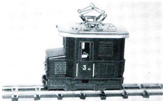
Bild 29 Ein Eggerbahn-Triebfahrzeug, eine Nachbildung einer Siemens-Schuckert-Lokomotive, Achsfolge B. Das kleine Fahrzeug mißt ganze 49 mm über Puffer, und das in H0!
