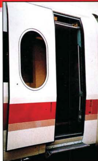
Die Druckwechsel bei Tunneldurchfahrten verlangen druckdichte Fenster und Türen. Foto: Schneider
