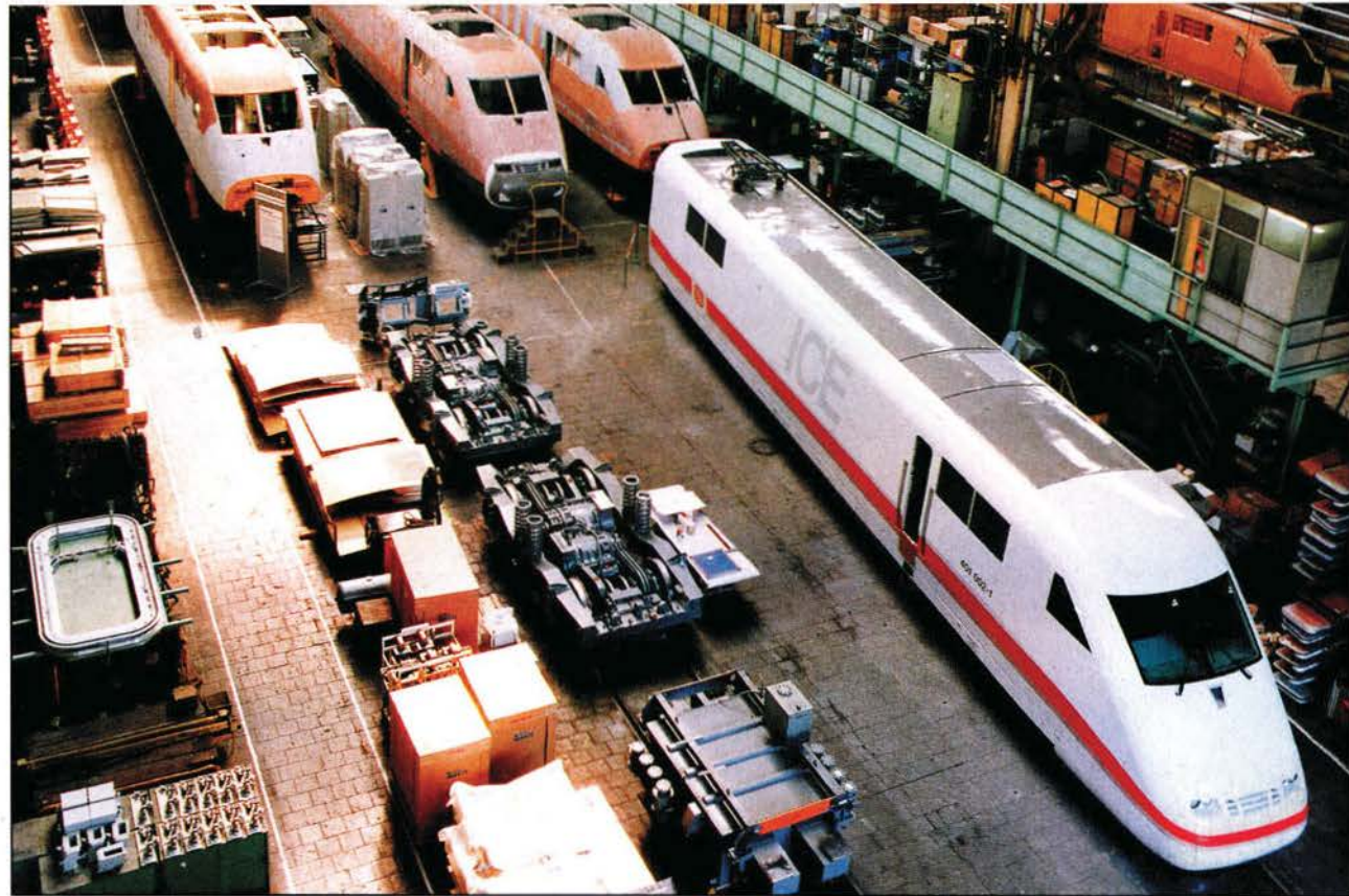
Endmontage von ICE-Triebköpfen bei Krupp-Maschinenteknik
