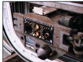
Geöffnete Kurzkupplung zwischen Triebkopf und Mittelwagen
