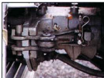
Kurzkupplung zwischen Triebkopf und Mittelwagen
