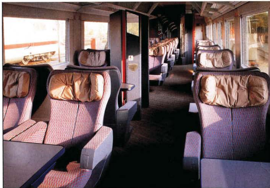
Gesamteindruck eines Großraumes 1. Klasse mit Garderobe als Raumteiler
