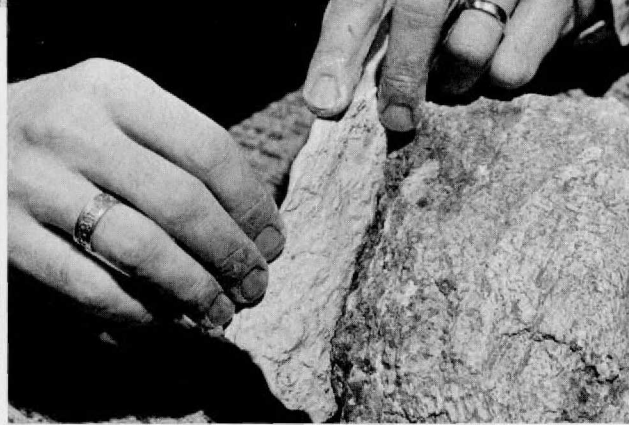
Abb. 9. Noch im feuchten Zustand wird die Knetmasse abgenommen, die Struktur ist jetzt schon erkennbar.
