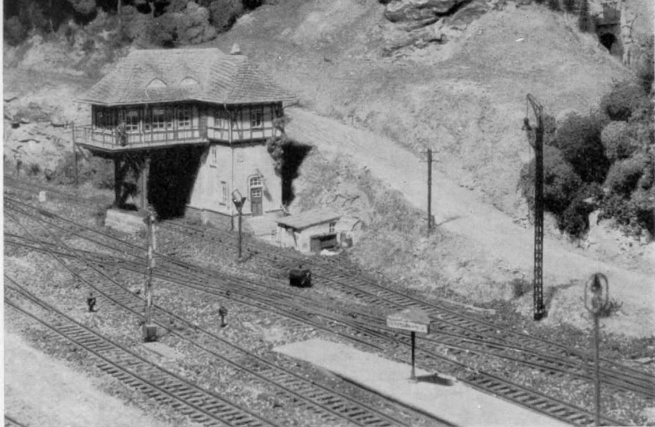
Abb. 1. Die südliche Ausfahrt von „Schreckenfels“ mit diversen „epochalen Basteleien“: bayerisches Ruhe-Halt-Signal (hier in Ru-Stellung), Gleissperre (rechts neben dem Signal an der rechten Schiene), beleuchtetes W-Signal (vorm Stellwerk) und beleuchtetes Stationsschild in der früher typischen Dreiecks-Form.
