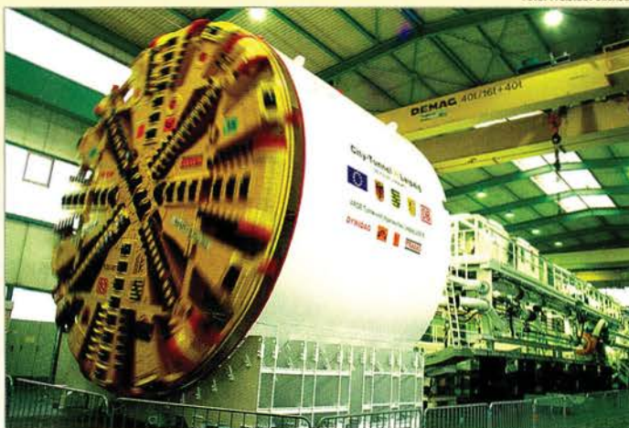
Die gigantische Leipziger Schildbohrmaschine absolviert im Februar 2006 bei ihrem Hersteller, der Herrenknecht AG, in Schwanau einen Probelauf.
