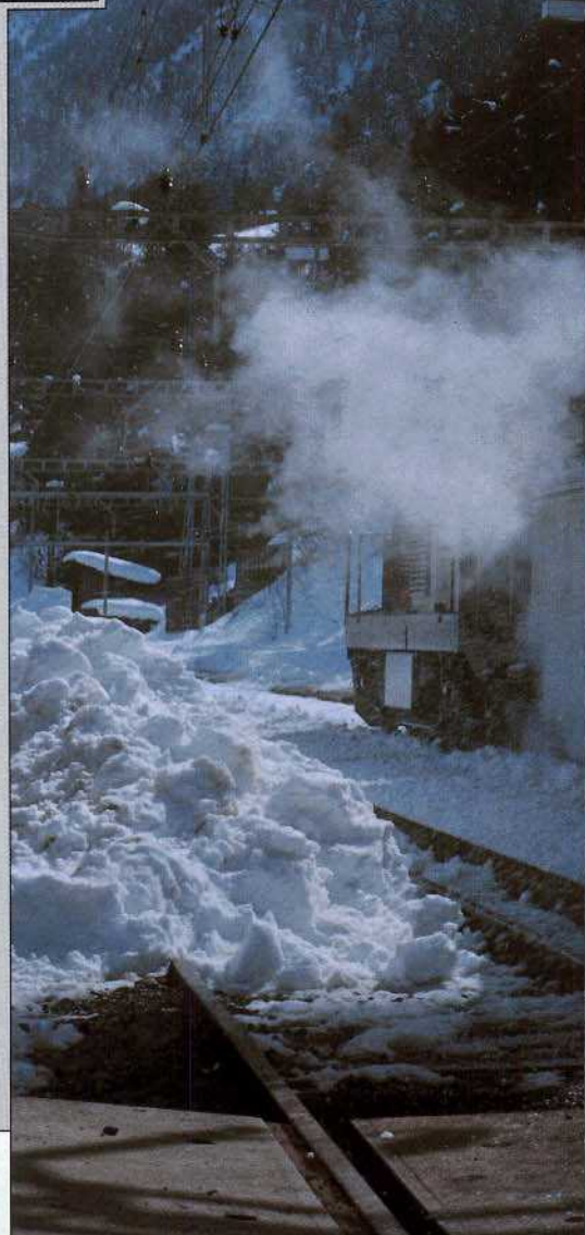
Bild 7: Die Rotary-Dampfschneeschleuder stößt Rauch und Schneestaub in die Luft (mittlere Meienreussbrücke bei Wassen).
