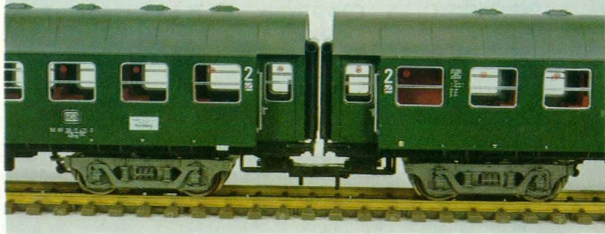
Abb. 3. Wirklich minimal ist der Luftspalt zwischen den Faltenbalgen bei Verwendung der (Roco-)Kurzkupplungsköpfe!
