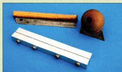
Oben: Drei einfache selbstgebaute Vorrichtungen zum Biegen dünner Bleche Links: Das praktische Biegegerät „The Bug“ ist in drei Größen erhältlich.
