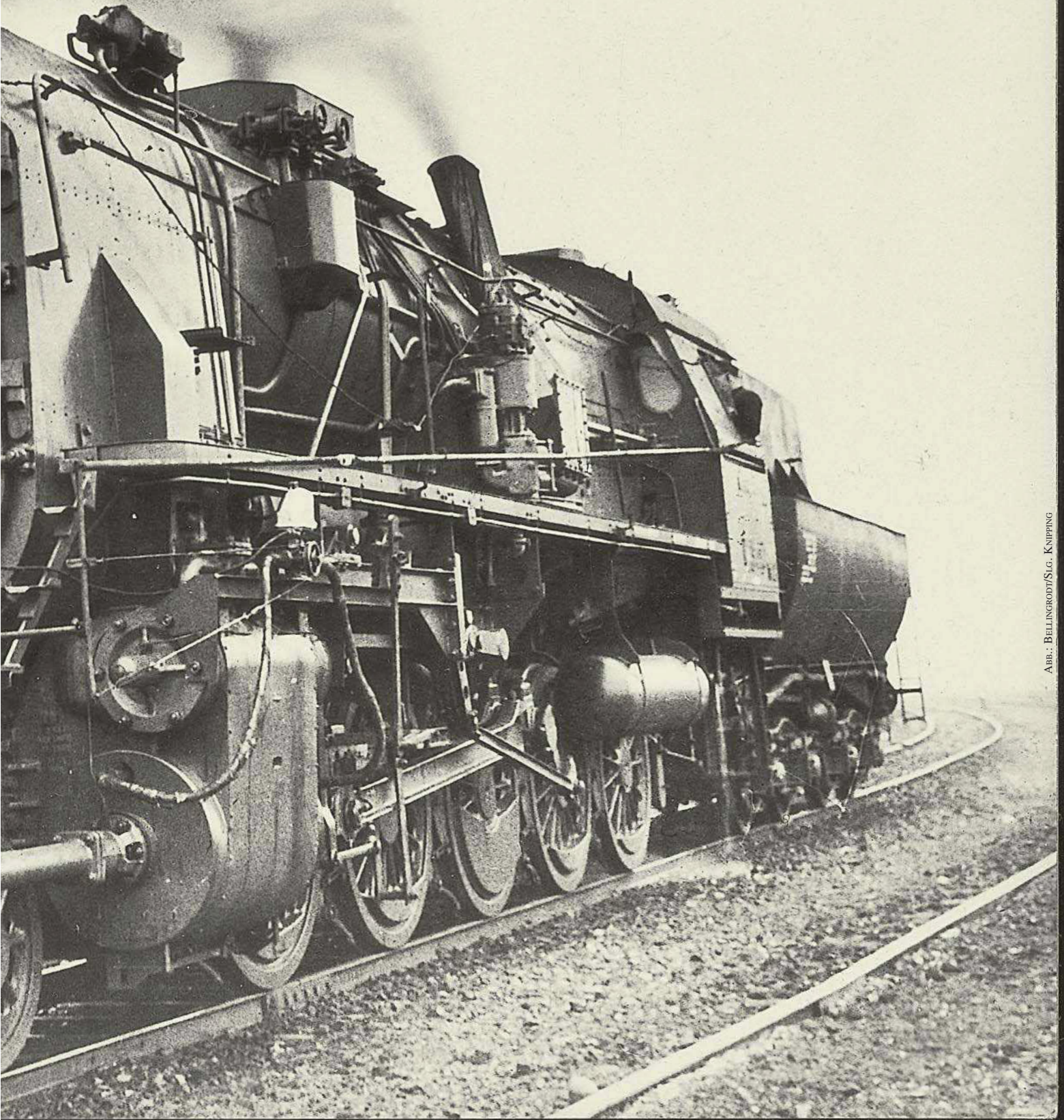
Eine der ersten beiden Franco-Crosti-Loks der Deutschen Bundesbahn: 42 9001 – hier aufgenommen am 28. Januar 1951, als die Maschine für einen Messzyklus des Lokversuchsamtes Minden mit Indiziereinrichtung und Messkabeln vorbereitet worden war.
