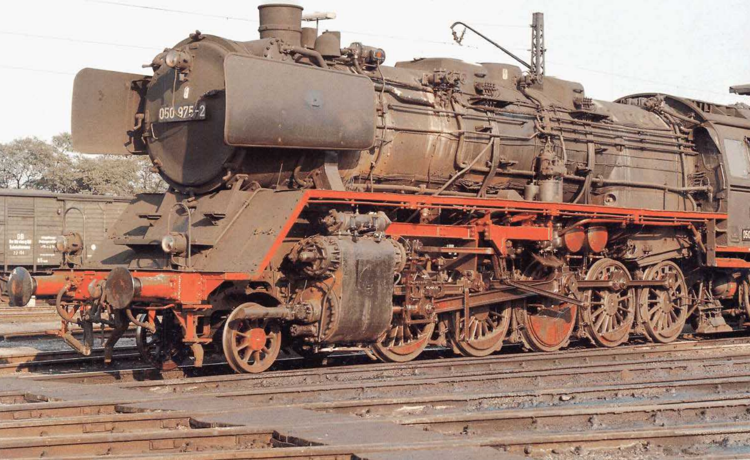
Bild 8: Die 050 975 weist zwei Besonderheiten auf: Für den Einsatz bei Meßfahrten als Bremslok verfügte sie über eine Riggensbach-Gegendruckbremse, und im Gegensatz zu den meisten Schwesterlokomotiven besaß sie noch Anfang der siebziger Jahre ihre Frontschürze (26.09.1972). Foto: J. Nelkenbrecher
