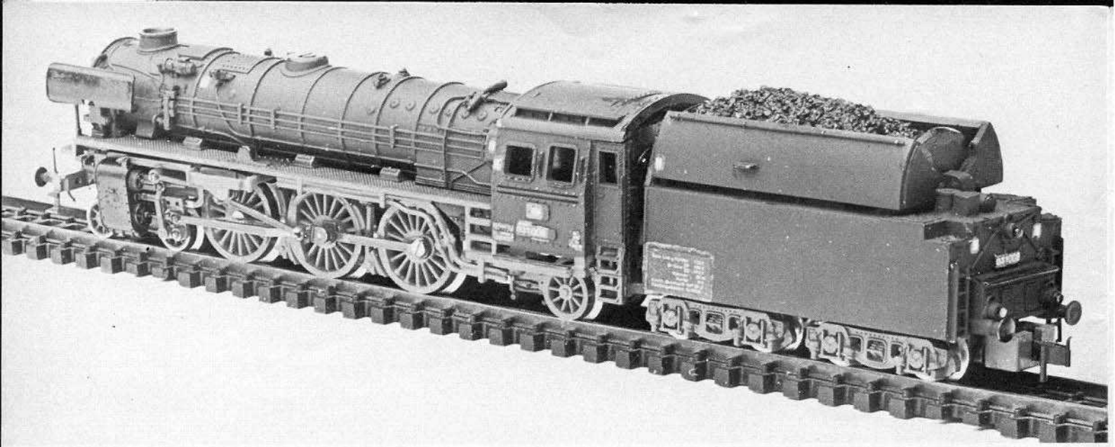
Bild 1: Die auffälligsten Merkmale der 03 10 gegenüber der normalen 01 oder normalen 03 sind die Tenderabdeckklappen sowie die Kohlenachsiebehydraulik und die Führerhausverlängerungsteile in Form von geschlossenen Türen. Das Kolbenstangen-Schutzrohr des dritten Zylinders zwischen Rauchkammertüre und Pufferbohle trägt ein übriges dazu bei.
