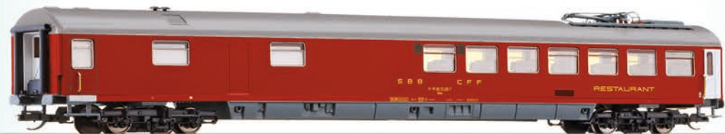
SBB Speisewagen mit Pantograph • WRm • Betriebsnummer 61 85 88-70 008-7 • Inneneinrichtung weiß • Durchsichtige Küchenfenster • Freelance Basis WR 135 • Zusätzliche Dachlüfter/Türbedruckung/gelbe Handgriffe • Revision 1974 • Handmuster
