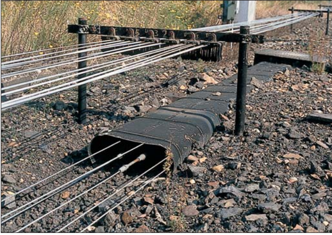
Hier werden mehrere Leitungen in einen Kanal zusammengeführt, wo sie wenig später abgelenkt werden um ein Gleis zu kreuzen.
