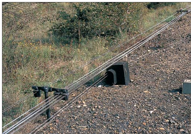
Muss eine Drahtzugleitung um mehr als 5° abgelenkt werden, machen sich Druckrollen erforderlich. In Bildmitte eine Druckrolle für eine Doppelleitung.
