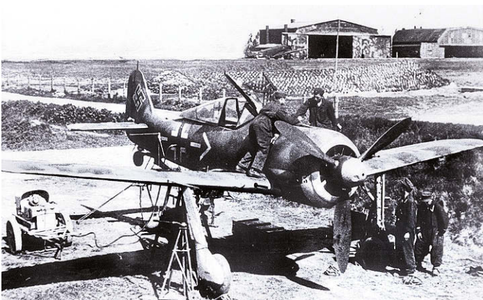
Unter Feldbedingungen werden hier die Bordwaffen einer Fw 190 der II./JG 54 in Dorpat justiert
