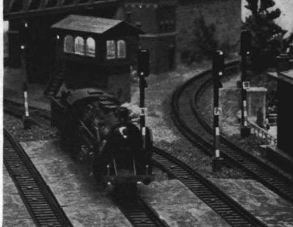
N Abb. 9. Drei in die Anlage eingebaute Lichtsignale. Aus WiWeW's „Dämmerlicht“-Aufnahme geht hervor, wie wohlproportioniert und „lichtintensiv“ die Lichtsignale — trotz der winzigen Austrittsöffnungen der Lichtleitkabel — sind.
