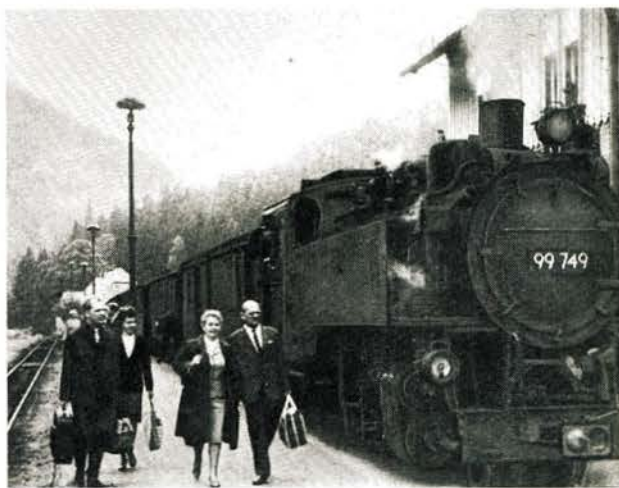
Bild 7 Die Lokomotiven der Baureihe 99 71 verfügen über eine Leistung von 600 PS und sind für die steilen Gebirgsstrecken besonders gut geeignet
