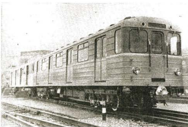
Bild 7 Metro-Wagenzug aus dem Waggonbauwerk Riga (UdSSR). Alu-Wagenkasten, stufenlose Thyristorsteuerung, automatische Geschwindigkeitsregelung, luftgedernte Drehgestelle, automatische Zugsteuerung auf der Basis von Pulsstellern
