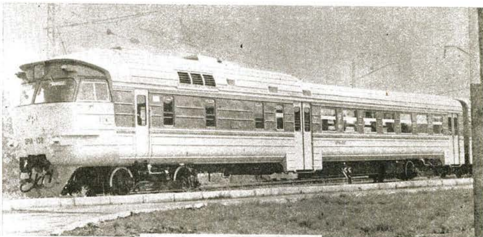
Bild 8 Dieseltriebwagenzug der Baureihe DR 1 A aus dem Waggonbauwerk Riga (UdSSR). Endwagen gleich Triebwagen mit je einem 1000-PS-Dieselmotor, Anfahrbeschleunigung 0,56 m/s 2 , Sitzplatzangebot bei Vierwägenzug für 384 Personen, Höchstgeschwindigkeit 140 km/h
