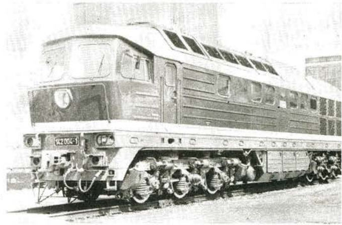
Bild 4 Diesellokomotive der Baureihe 142 aus dem Lokomotivbauwerk „Oktoberrevolution“ Woroschilowgrad (UdSSR). Speziell für den Einsatz bei der DR entwickelt. Länge über Puffer 20 820 mm, Dieselmotorleistung 4000 PS, Anfahrzugkraft 35 Mp, elektrische Zugheizanlage, Höchstgeschwindigkeit 120 km/h
