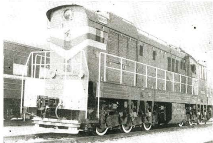
Bild 5 Diesellokomotive der Baureihe ČME 3 aus dem Diesellokomotivwerk Sokolow (CSSR). Speziell für die Sowjetischen Eisenbahnen entwickelt. Länge über Kupplung 17 220 mm, Dieselmotorleistung 1350 PS, Motordrehzahl 700 min -1 , Anfahrzugkraft 31 Mp, Höchstgeschwindigkeit 95 km/h
