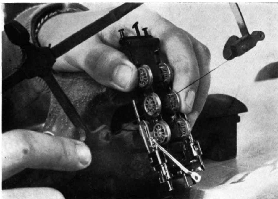
Abb. 2. Dieses Bild demonstriert das Durchsägen der Radspeichen. Nach Demontage von Gehäuse, Motor, Umschaltrelais, Lampen und Kuppelstangen wird das Fahrwerk vorsichtig in einen Schraubstock gespannt. Die Speichen können ohne weiteres leicht schräg durchsägt werden.
