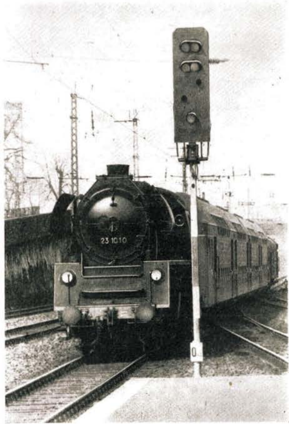
Bild 1 Ein Lichthauptsignal des Vorbildes. Die Lokomotive gehört nach der Ummumerierung der DR zur BR 35
