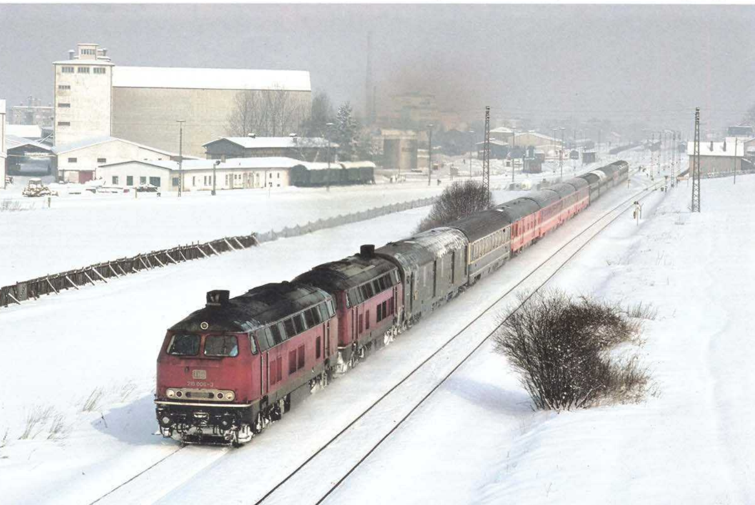
Bild 14: Die acht Diesellokomotiven der Baureihe 210 waren vom Januar 1971 bis zum September 1983 beim Bw Kempten beheimatet. Die Maschinen besaßen außer einem 2500 PS starken Dieselmotor noch eine Zweiwellen-Gasturbine, die eine zusätzliche Leistung von 1200 PS erbrachte. Dennoch mußten die Schnellzüge auf der Allgäubahn in Doppeltraktion gefahren werden. Im Januar 1978 führen die 210 006 und eine Schwesterlokomotive bei Buchloe den D 366 "Ticino" (München — Zürich — Mailand). Foto: W. Bier
