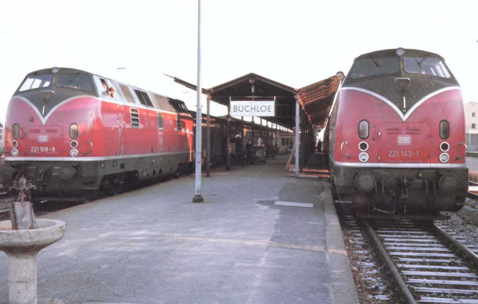
Bild 13: Die ersten V 200.0 kamen im Jahr 1961 zum Bw Kempten. Diese waren jedoch den hohen Anforderungen auf den Allgäuer Bergstrecken nicht gewachsen und wurden bald wieder abgezogen. Erst die wesentlich stärkere Baureihe V 200.1 konnte die Lokomotiven der Baureihe 18.6 im Schnellzugdienst ersetzen. 1971 trafen sich in Buchloe die 221 106 und die 221 143. Foto: R. Bier
