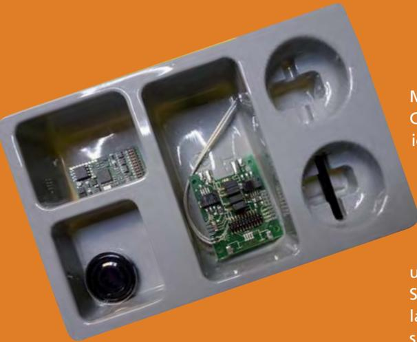
*Der ordentlich verpackte Umbausatz von Märklin beinhaltet die Motor-Adapterplatte mit den Lichtanschlüssen und der 21-poligen MTC-Decoderschnittstelle für den Sounddecoder, den Decoder 60949 sowie den Lautsprecher mit Haltebügel.*
