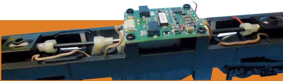
Die Stromversorgung des Decoders wurde entlötet, die flexiblen Leiterbahnen der Beleuchtung mit einer Pinzette herausgezogen.
