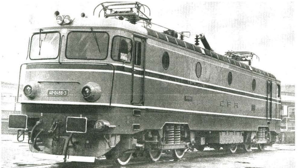
Bild 1 25 kV, 50 Hz — elektrische Lokomotive, Hersteller Electroputere Craiova (SR Rumänien). Fast 500 Stück dieser Baureihe sind bei der Rumänischen Staatsbahn im Einsatz; 100 in Jugoslawien. Für eine Stundenleistung von 5400 kW und eine maximale Anfahrzugkraft von 412 kN ausgelegt, beträgt die Höchstgeschwindigkeit der 19800 mm langen und 120 t schweren, universell einsetzbaren Maschine 120 km/h.
