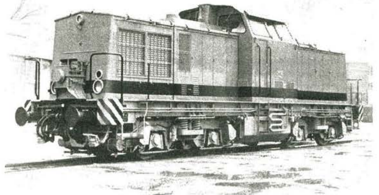
Bild 2 Diesellokomotive, Baureihe V100, Motorleistung 736 kW, Hersteller Kombinat LEW „Hans Beimler“ Hennigsdorf. Die im Bild gezeigte Ausführungsvariante 5 hat als Besonderheit die Möglichkeit zum Anschluß einer Grabenräumeinheit (GRE). Eigens deshalb ist der Dieselmotor mit einem zweiten Abtriebsflansch ausgerüstet. Das für den GRE-Antrieb erforderliche Zwischenlager, untergebracht auf der vorderen Plattform des Umlaufs, ist auf dem Bild erkennbar.
