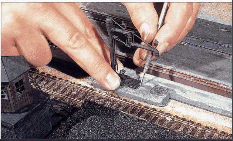
Bild 6: In die ausgehärtete Masse lassen sich mit Reißnadel und Skalpell u.a. auch die Wasserkräne perfekt und bündig einarbeiten.
