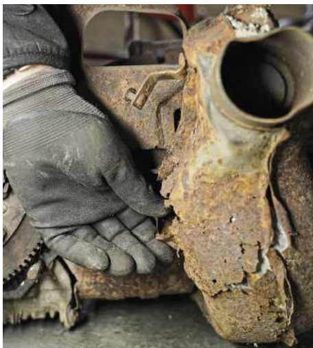
Scheppert es während der Fahrt, sind hier abgerostete Wärmeleitbleche die Ursache
