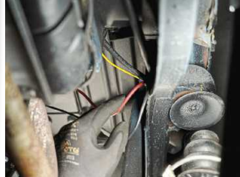
Brandgefährlich sind sogenannte Freilandverdrahtungen unterm Blech
