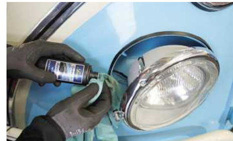
Ausgehärtete Dichtungen werden mit einem Spezialmittel wieder elastisch
