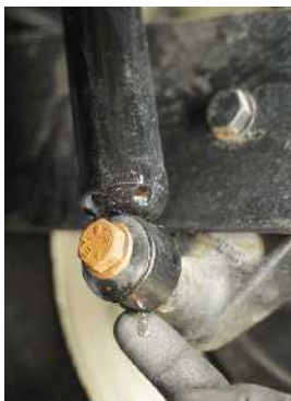
Spätestens wenn das Öl tropft, sind die Dämpfer verschlissen
