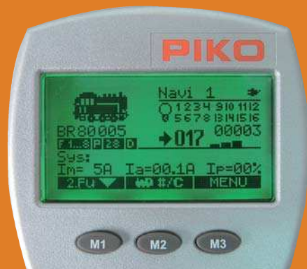
Bildschirm im Normalbetrieb: Der Bediener hat alle Funktionen im Blick. Die Fahrstufe wird sowohl numerisch als auch in Form eines Balkendiagramms angezeigt. Im unteren Displaybereich können aktuelle Leistungsdaten des Systems eingeblendet werden.
