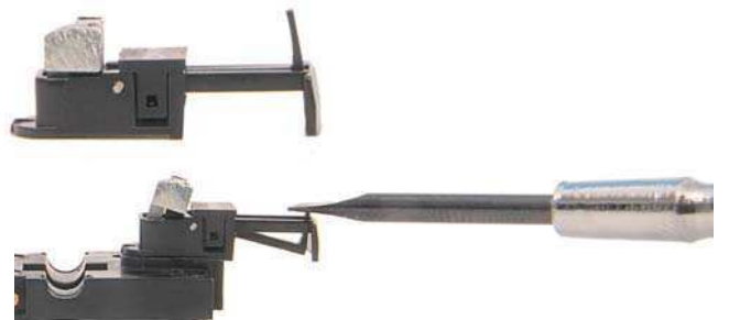
Oben die Kupplung in Ruhestellung, das Gewicht auf dem Hebelarm drückt den Haken nach oben. Unten die Arbeitsstellung, hier bewusst durch Druck mit einem Schraubenzieher herbeigeführt. „In echt“ drückt eine Zahnstange das Gewicht nach oben.
