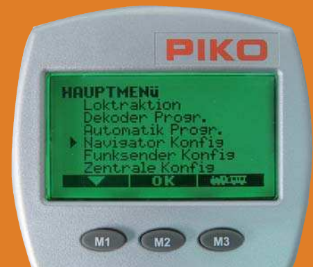
Das Hauptmenü des Piko-Navigators enthält sechs Konfigurationspunkte. Während die Punkte „Navigator Konfig“ und „Funksender Konfig“ grundlegende Systemeinstellungen erlauben, enthält der Punkt „Zentrale Konfig“ gegenwärtig keine Einstellmöglichkeiten.
