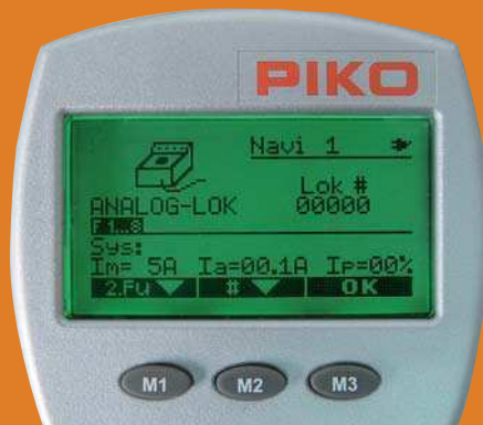
Mit Pikos neuem Digitalsystem können auch analoge Loks gefahren werden. Das System verwendet dazu die Adresse 0. Allerdings liegt an den Gleisen permanent gepulste Digitalspannung an, weshalb diese Betriebsart nicht auf Dauer verwendet werden sollte.
