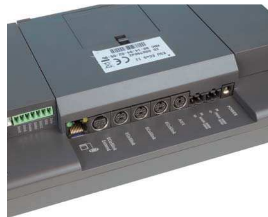
Blick auf die Gehäuserückseite der ECoS 2. Das Batteriefach dient der Aufnahme von Akkus als unterbrechungsfreie Stromversorgung.
