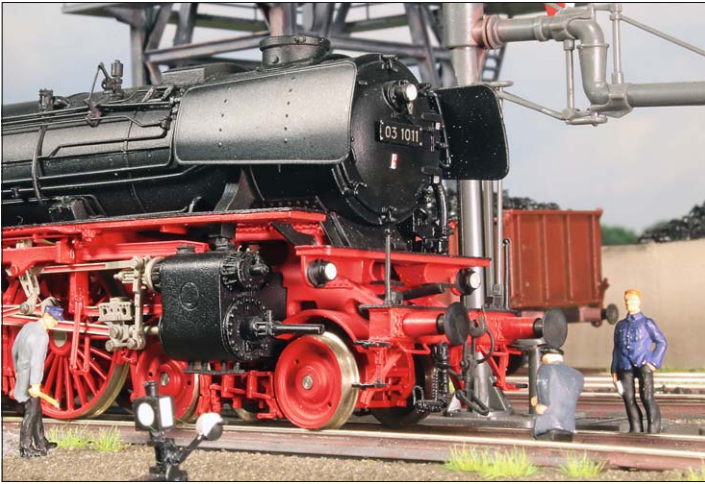
Treib- und Kuppelstangen sowie die Steuerung besaßen viele Lager. Hier kontrolliert der Lokführer die Lager direkt nach der Fahrt, um Heißläufer zu identifizieren. Die Ölgefäße der Stangenlager werden aufgefüllt.
