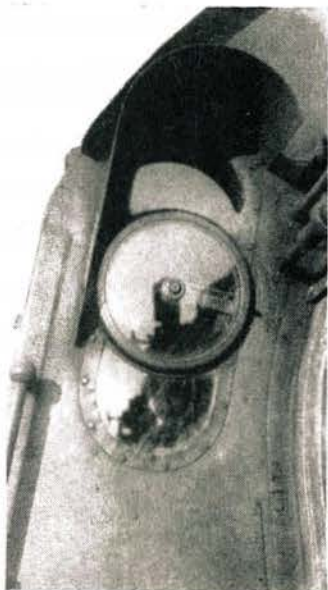
Bild 1 Lokomotive 52 001 mit abgeklapptem Schornsteindeckel.
