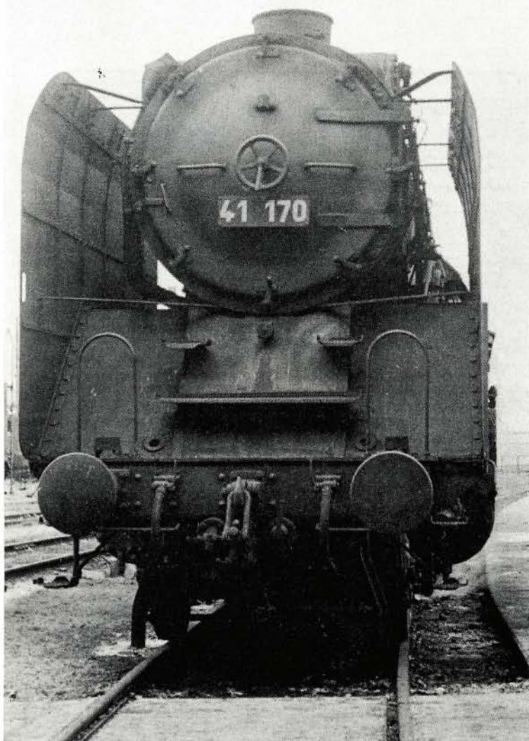
Bild 10: Vier verschiedene Stirnansichten der Baureihe 41 im Vergleich. Hier die 41 170 in Ursprungsausführung mit Wagner-Windleitblechen (Juli 1940). Foto: Dr. Scheingraber
