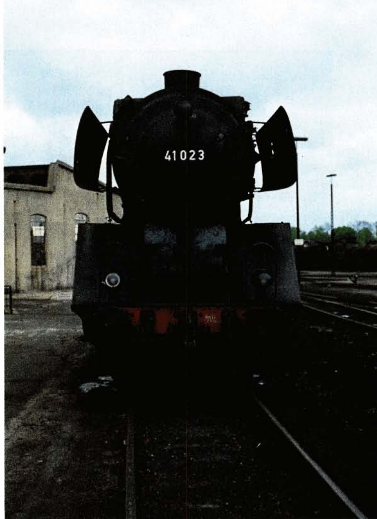
Bild 11: Stirnansicht der 41 023 des Bw Rheine mit Witte-Windleitblechen (8. Mai 1966). Foto: J. Schweichler
