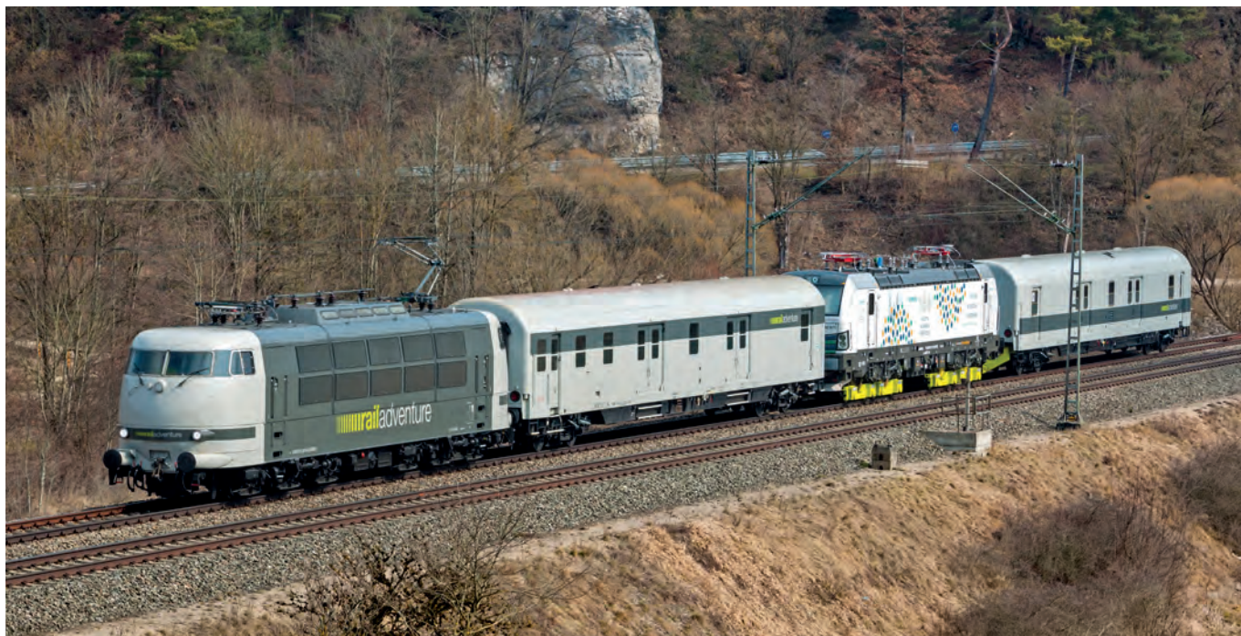
Auf Hilfsdrehgestellen absolvierte die breitspurige 193 971 (Vectron) die erste Etappe ihrer langen Reise nach Finnland. Als Zuglok fungierte dabei die 103 222 des Münchner EVU RailAdventure. Am 15. März zeigte sich die außergewöhnliche Fuhre im Altmühltal. Foto: Dollinger
