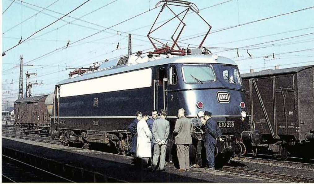
Bild 11: Aufnahme der 1963 als Versuchslokomotive für Tempo 200 ausgerüsteten E 10 299. Mit Pufferverkleidung und Frontschürze wirkte die blau lackierte Maschine ebenso elegant wie die E 10.12 und später die E 03.
