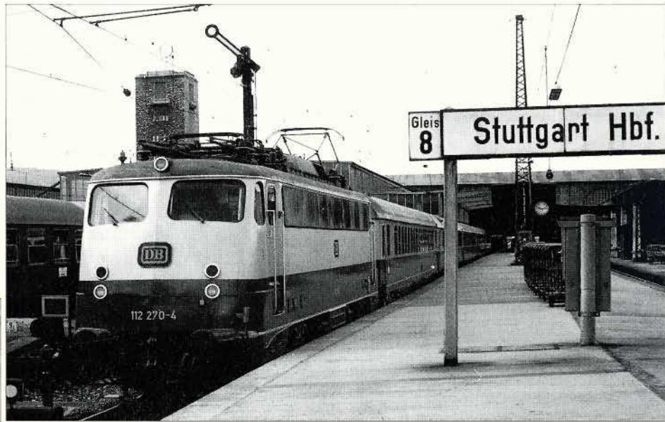
Bild 8: Neben den als Versuchslok für 200 km/h ausgerüsteten E 10 299 und 300 fuhr die E 10 1270 der ersten E 10.12-Serie – hier eine spätere Aufnahme als 112 270 – im Jahre 1963 versuchsweise als erste E 10 bis 180 km/h schnell. Abb.: DB, Sammlung Bázold
