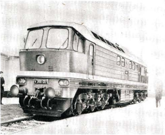
Bild 1 Neuentwickelte 3000-PS-Diesellokomotive aus Woroschilowgrad (UdSSR). Zur vorigen Frühjahrsmesse noch als Modell gezeigt, wurde sie in diesem Jahr als V 300 001 vorgestellt. Ihre Höchstgeschwindigkeit beträgt 140 km/h.
