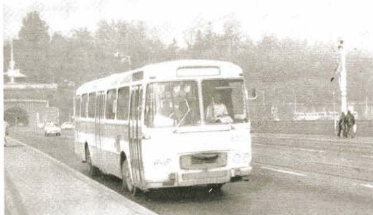
Bild 11 Stadtomnibus des Typs SM 11 Länge 10985 mm, Breite 2,5 m, 31 Sitz- und 55 Stehplätze Antriebsleistung 180 PS, Höchstgeschwindigkeit
