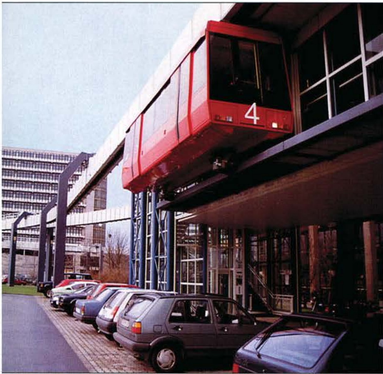
Der Fahrweg: Er bietet Platz, damit Autos darunter parken können. Ein Vorteil der H-Bahn.
