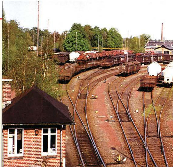
In Paderborn Nord werden die Schadhafte Güterzüge aufgelöst und anschließend auf den Werkgleisen nach Schadgruppen und Gattungen sortiert.
