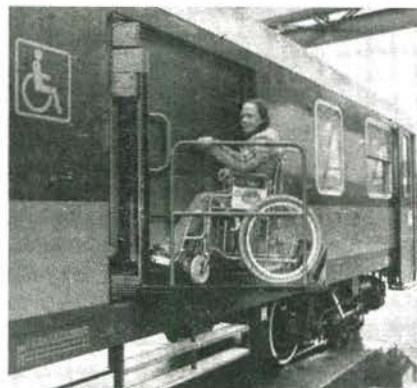
Die vom VEB Waggonbau Bautzen ausgelieferten Wagen erhielten bei den ČSD die Nummern 5154-70 001-7 bis 5154-70 074-2 (BDmee, ohne Hubbühne) und 5154-70 075-1 bis 5154-70 100-7 (BDmee mit Hubbühne). Deutlich ist auf dem Foto die Hubbühne erkennbar. Foto: A. Richter, Tharandt
