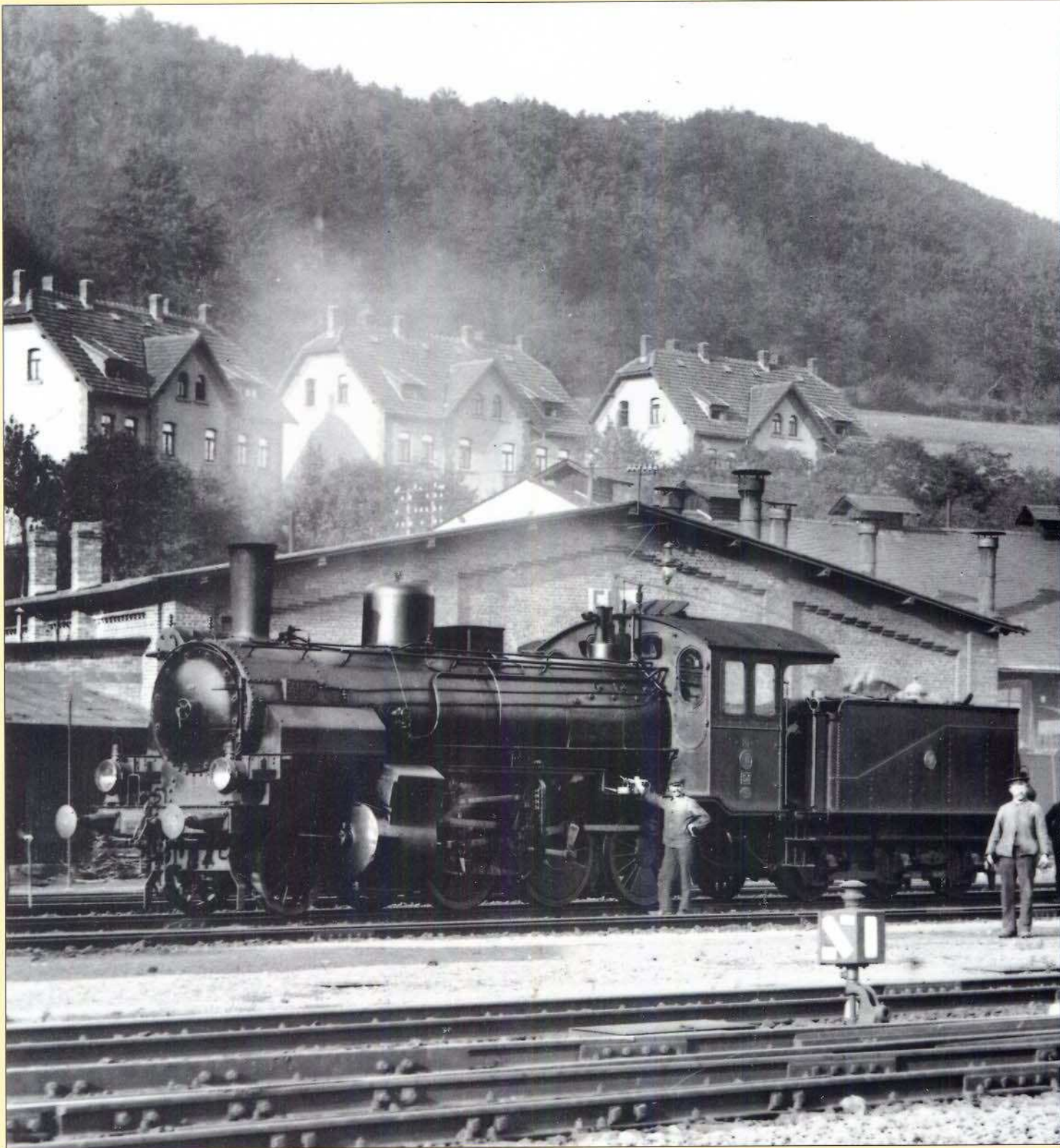
Bild 3: Die (G 5') Frankfurt 4194 steht um 1910 im Bahnhof Elm. Ganz rechts ist eine anfahrende S 7 (Bauart Grafenstaden) zu erkennen. Bevor es den
